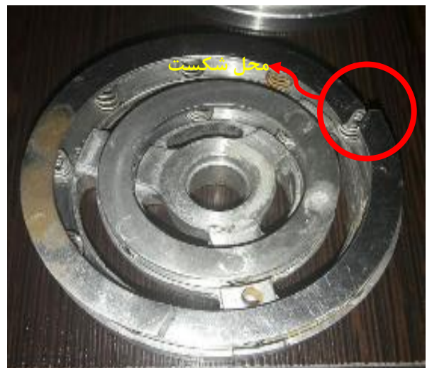
شکل (۴). تصویری از یک سوپاپ شکسته شده کمپرسور [۴۶]
