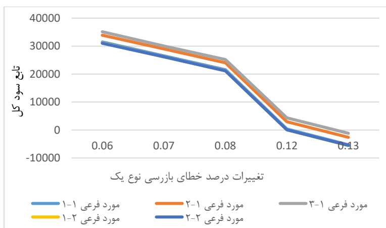
شکل (۱۲): تأثیر تغییرات درصد خطای بازرسی نوع یک بر تابع سود کل در مدل بدون یادگیری مؤثر در کاهش خطای بازرسی
